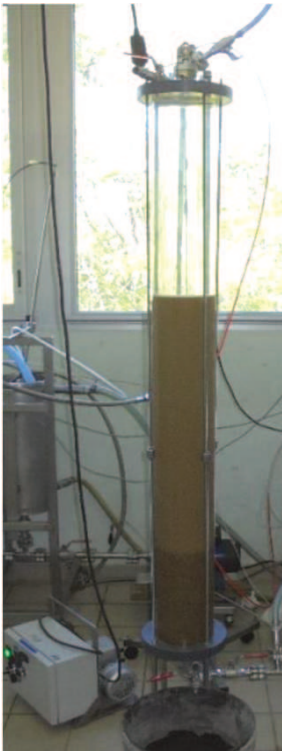
Banc d'essais IFTS adaptable aux divers milieux filtrants
