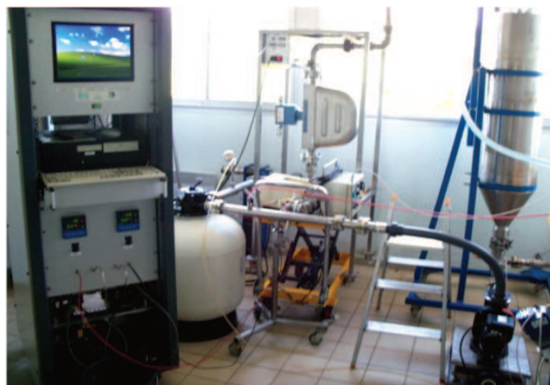
Banc d'essais IFTS adaptable aux divers milieux filtrants
